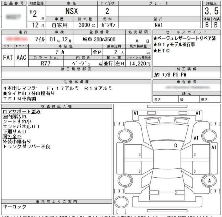
A:キズ U:ヘコミ B:セズを伴うヘコミ P:要塗装 W:補修跡 S:錆 C:腐食、穴 G:フロンや゙ラス点キズ XX:交換済み X:要交換 欠:欠品 内・外装評価 5段階ランク順(A+B+C+D+E) 1
